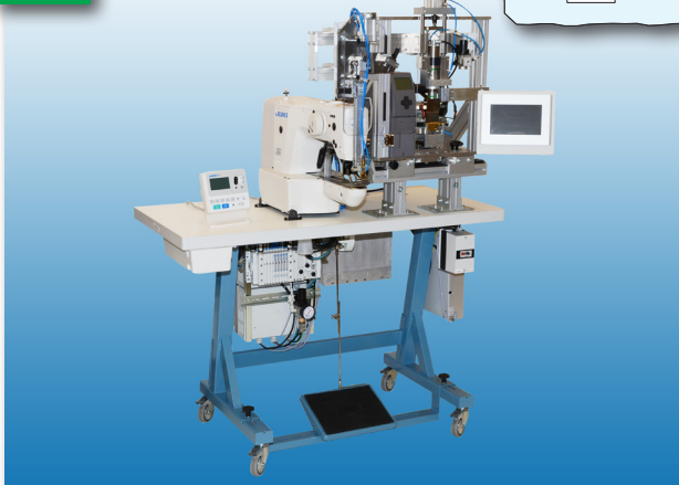
Etiketten drucken, schneiden, zuführen und annähen
